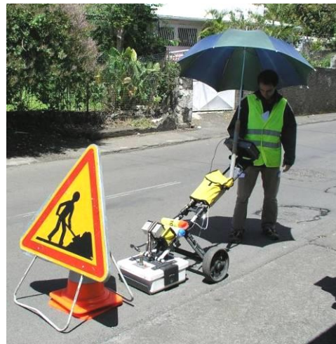
Figure 1 : détection des réseaux à Saint-André
