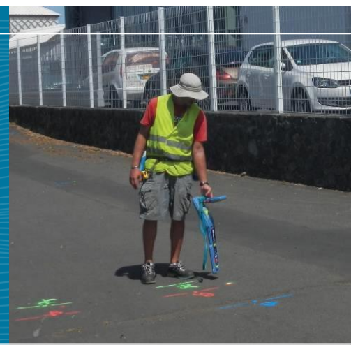
Figure 4 : Détecteur électromagnétique en action à Saint Denis
